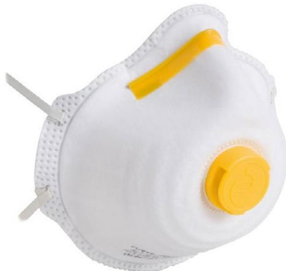
**Facciale filtrante mono-uso** contro aerosol solidi e liquidi, il cui corpo è costituito da una conchiglia anatomica termoformata e multistrato, che consente una filtrazione progressiva ed un confortevole contatto con la pelle. L'uniforme aderenza sul viso dell'utilizzatore è assicurata da una doppia bardatura elastica.
